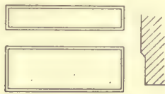
Abb. 155. Wandquader. Ansicht 1:50 nebst Schnitt 1:5.
